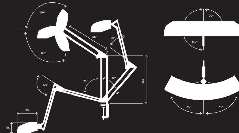
La particolare forma del riflettore offre una risposta illuminotecnica ad un vasto pubblico che, alla ricerca di un punto luce, non si accontenta di una forma rotonda o rettangolare. Il braccio a pantografo garantisce un'ampia ed affidabile movimentazione.
